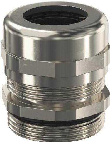
Robuste Kabelverschraubung mit metrischem Anschlussgewinde nach IEC 423 in Hutmutterbauart für hohe Dichtigkeitsansprüche. Zugentlastung, Verdrehschutz und Dichtigkeit über den gesamten Spannbereich. Dichtring aus Neopren. Klemmeinsatz aus Polyamid. Mit vormontiertem Dichtring am Anschlussgewinde, VDE-geprüft nach DIN EN 50262, Schutzart IP68 bei 5 bar/1h, Temperaturereinsatzbereich -20 bis +100°C.
