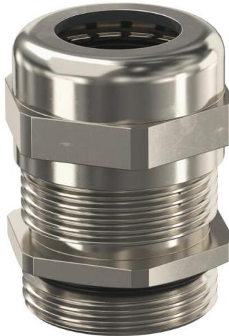
Pressacavo con filettatura di raccordo metrica secondo IEC 423, tipo costruttivo a dado cieco per una forte tenuta. Scarico di trazione, protezione antitorsione e tenuta sull'intero campo di serraggio. Anello di guarnizione in neoprene. Inserto di fissaggio in poliammide. Con anello di tenuta premontato sulla filettatura di raccordo, testato VDE secondo DIN EN 50262, tipo di protezione IP68 a 5 bar/1h, range di temperatura di lavoro da -20 a +100°C.
