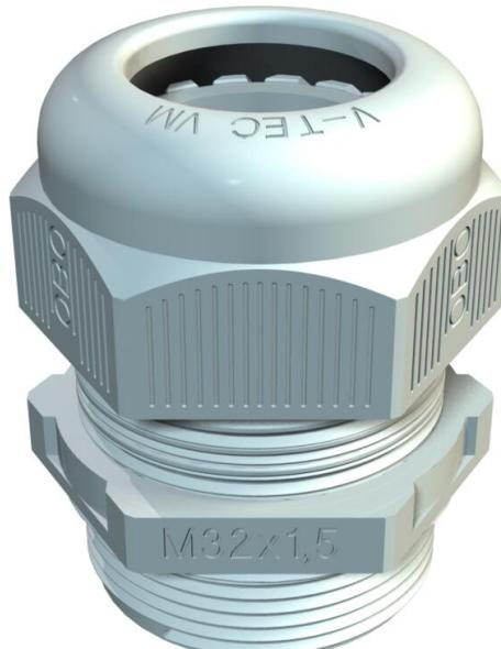
Presse-étoupe avec raccord fileté métrique de type écrou borgne, pour boîtes de dérivation, boîte, coffret de distribution dans le domaine privé et industriel. Avec décharge de traction et lèvre d'étanchéité intégrée, testé selon la norme DIN EN 62444. Niveau de protection IP68. Utilisation possible de -20 °C à +65 °C
