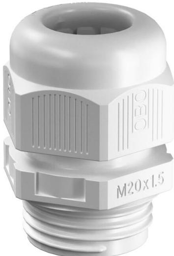
Presse-étoupe avec raccord fileté métrique de type écrou borgne, pour boîtes de dérivation, boîte, coffrets de distribution dans le domaine privé et industriel. Avec décharge de traction et lèvre d'étanchéité intégrée, testé selon la norme DIN EN 62444. Niveau de protection IP68. Utilisation possible de -20 °C à +65 °C
