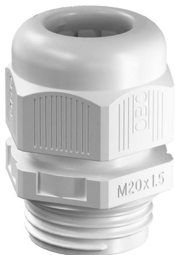
Kabelverschraubung mit metrischem Anschlussgewinde in Hutmutterbauart, für Kabelabzweigkästen, Gehäuse, Verteilerschränke im privaten und industriellen Bereich. Mit Zugentlastung und integrierter Dichtlippe, geprüft nach DIN EN 62444. Schutzklasse IP68. Einsetzbar von -20°C bis +65°C.
