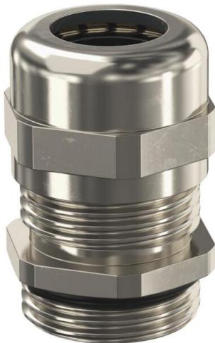
Pressacavo con filettatura di raccordo metrica secondo IEC 423, tipo costruttivo a dado cieco per una forte tenuta. Scarico di trazione, protezione antitorsione e tenuta sull'intero campo di serraggio. Anello di guarnizione in neoprene. Inserto di fissaggio in poliammide. Con anello di tenuta premontato sulla filettatura di raccordo, testato VDE secondo DIN EN 50262, tipo di protezione IP68 a 5 bar/1h, range di temperatura di lavoro da -20 a +100°C.
