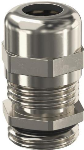
Pressacavo con filettatura di raccordo metrica secondo IEC 423, tipo costruttivo a dado cieco per una forte tenuta. Scarico di trazione, protezione antitorsione e tenuta sull'intero campo di serraggio. Anello di guarnizione in neoprene. Inserto di fissaggio in poliammide. Con anello di tenuta premontato sulla filettatura di raccordo, testato VDE secondo DIN EN 50262, tipo di protezione IP68 a 5 bar/1h, range di temperatura di lavoro da -20 a +100°C.
