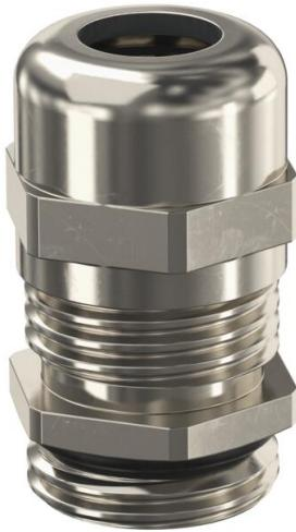
Presse-étoupe robuste de type écrou borgne avec filetage métrique selon la norme CEI 423, pour des exigences d'étanchéité élevées. Décharge de traction, protection antitorsion et étanchéité pour l'ensemble de la plage de serrage. Bague d'étanchéité en néoprène. Garniture de serrage en polyamide. Avec bague d'étanchéité prémontée sur le raccord fileté, testé VDE selon la norme DIN EN 50262, indice de protection IP68 à 5 bar/1 h, plage de température de -20 à +100 °C.
