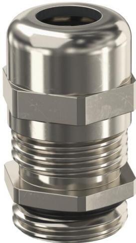
Robuste Kabelverschraubung mit metrischem Anschlussgewinde nach IEC 423 in Hutmutterbauart für hohe Dichtigkeitsansprüche. Zugentlastung, Verdrehschutz und Dichtigkeit über den gesamten Spannbereich. Dichtring aus Neopren. Klemmeinsatz aus Polyamid. Mit vormontiertem Dichtring am Anschlussgewinde, VDE-geprüft nach DIN EN 50262, Schutzart IP68 bei 5 bar/1h, Temperaturereinsatzbereich -20 bis +100°C.
