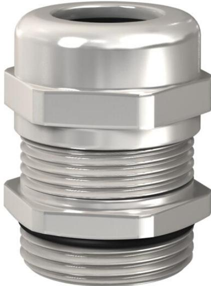
Pressacavo EMC robusto con filettatura di raccordo metrica secondo IEC 423, tipo costruttivo a dado cieco per una forte tenuta. Scarico di trazione e protezione antitorsione. Anello di guarnizione in neoprene. Inserto di fissaggio in poliammide. Con guarnizione toroidale di tenuta premontata sulla filettatura di raccordo, testato VDE secondo DIN EN 50262, grado di protezione IP 68 a 5 bar per 1 ora.
