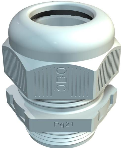
Presse-étoupe avec raccord fileté PF de type écrou borgne, pour boîtes de dérivation, boîte, coffret de distribution dans le domaine privé et industriel. Avec décharge de traction et lèvre d'étanchéité intégrée, testé selon la norme DIN EN 62444. Niveau de protection IP68. Utilisation possible de -20 °C à +65 °C
