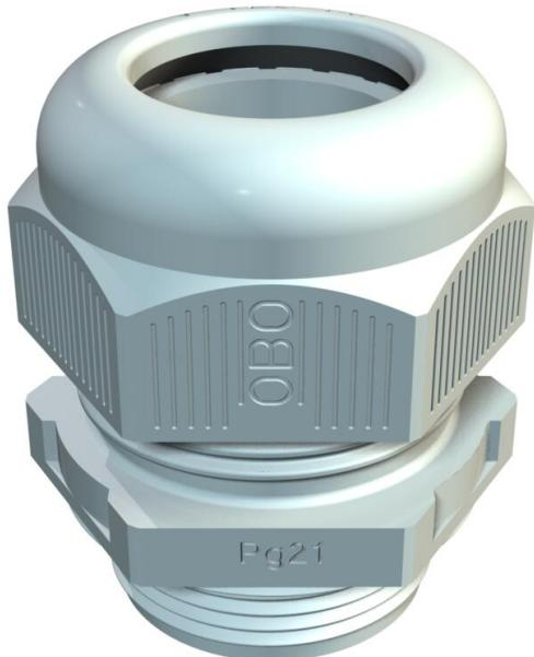
Kabelverschraubung mit PG-Anschlussgewinde in Hutmutterbauart, für Kabelabzweigkästen, Gehäuse, Verteilerkästen im privaten und industriellen Bereich. Mit Zugentlastung und integrierter Dichtlippe, geprüft nach DIN EN 62444. Schutzklasse IP68. Einsetzbar von -20°C bis +65°C.
