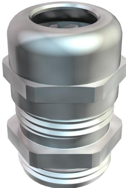
Kabelverschraubung in Hutmutterbauart mit großem Dichtbereich sowie Zugentlastung und Verdrehschutz für hohe Dichtigkeitsansprüche, mit PG-Anschlussgewinde nach DIN 40430. Klemmeinsatz aus Polyamid, Dichtring aus Chloroprene-Nitrilkautschuk, mit vormontiertem O-Ring am Anschlussgewinde.
