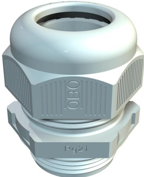
Pressacavo con filettatura PG, adatto per scatole di derivazione, per applicazioni residenziali ed industriali. Con scarico della trazione e guarnizione di tenuta integrata, testato secondo norma CEI EN 62444. Grado di protezione IP68. Range temperatura -20°C a +65°C.
