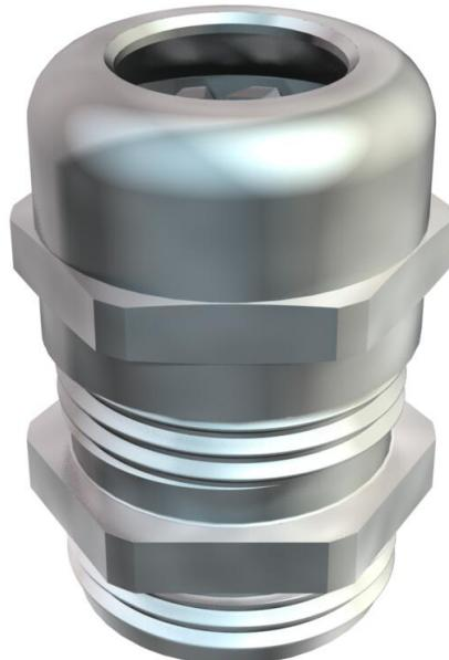
Kabelverschraubung in Hutmutterbauart mit großem Dichtbereich sowie Zugentlastung und Verdrehschutz für hohe Dichtigkeitsansprüche, mit PG-Anschlussgewinde nach DIN 40430. Klemmeinsatz aus Polyamid, Dichtring aus Chloroprene-Nitrilkautschuk, mit vormontiertem O-Ring am Anschlussgewinde. Schutzart IP68 bei 5 bar/1 h, geprüft nach DIN EN 62444. Anschlussgewindelänge „normal“, in Anlehnung an DIN 46320.
