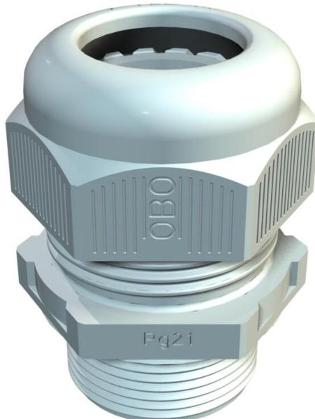
Pressacavo con filettatura PG, adatto per scatole di derivazione, per applicazioni residenziali ed industriali. Con scarico della trazione e guarnizione di tenuta integrata, testato secondo norma CEI EN 62444. Grado di protezione IP68. Range temperatura -20°C a +65°C.
