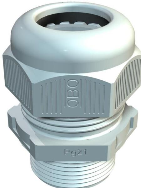
Kabelverschraubung mit PG-Anschlussgewinde in Hutmutterbauart, für Kabelabzweigkästen, Gehäuse, Verteilerkästen im privaten und industriellen Bereich. Mit Zugentlastung und integrierter Dichtlippe, geprüft nach DIN EN 62444. Schutzklasse IP68. Einsetzbar von -20°C bis +65°C.
