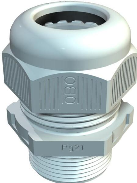
Presse-étoupe avec raccord fileté PF de type écrou borgne, pour boîtes de dérivation, boîte, coffret de distribution dans le domaine privé et industriel. Avec décharge de traction et lèvre d'étanchéité intégrée, testé selon la norme DIN EN 62444. Niveau de protection IP68. Utilisation possible de -20 °C à +65 °C
