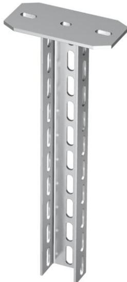
Profilato di sospensione (profilato a U) con supporto a soffitto saldato. Per il fissaggio a soffitti in calcestruzzo orizzontali e supporti in acciaio. Nel caso si utilizzino mensole di lunghezza 400 millimetri o oltre oppure si montino le mensole alla fine del supporto di sospensione si consiglia di utilizzare il distanziatore, tipo DSK 61.
