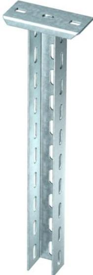
Pendar (profilé en U) de dimensions 50 x 50 mm avec plaque de tête soudée. Pour la fixation au plafonds en béton horizontaux et poutres métalliques horizontales. À partir d'une largeur de 400 mm ou en cas de montage de la console sur l'extrémité du pendar, il convient d'utiliser l'entretoise de type DSK 45. ensemble avec la vis à tête hexagonale M10x80.
