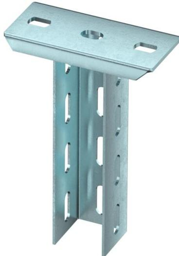
Profilato di sospensione (profilato a U) con supporto a soffitto saldato. Per il fissaggio a soffitti in calcestruzzo orizzontali e supporti in acciaio. Nel caso si utilizzino mensole di lunghezza 400 millimetri o oltre oppure si montino le mensole alla fine del supporto di sospensione si consiglia di utilizzare il distanziatore, tipo DSK 45.
