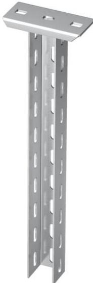
Profilato di sospensione (profilato a U) con supporto a soffitto saldato. Per il fissaggio a soffitti in calcestruzzo orizzontali e supporti in acciaio. Nel caso si utilizzino mensole di lunghezza 400 millimetri o oltre oppure si montino le mensole alla fine del supporto di sospensione si consiglia di utilizzare il distanziatore, tipo DSK 45
