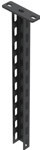
Pendar (profilé en U) de dimensions 50 x 30 mm avec semelle de recouvrement soudée. Pour la fixation au plafonds en béton horizontaux et poutres métalliques horizontales. Revêtement par poudrage en noir profond (RAL 9005). À partir d'une largeur de console de 400 mm ou du montage de celle-ci à l'extrémité du pendar, il convient d'utiliser l'entretoise DSK 25.
