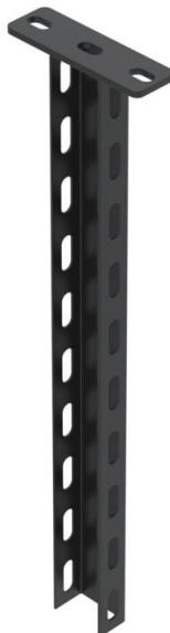
Hängestiel (U-Profil) in der Abmessung 50 x 30 mm mit angeschweißter Kopfplatte. Zur Befestigung an waagerechten Betondecken und Stahlträgern. Pulverbeschichtet in tiefschwarz (RAL 9005). Ab der Auslegerbreite 400mm oder der Montage des Auslegers am Ende des Hängestieles empfiehlt sich der Einsatz des Distanzstücks Typ DSK 25.
