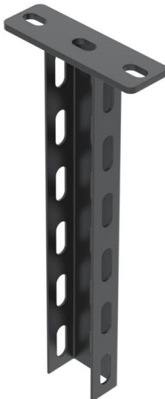
Pendar (profilé en U) de dimensions 50 x 30 mm avec semelle de recouvrement soudée. Pour la fixation au plafonds en béton horizontaux et poutres métalliques horizontales. Revêtement par poudrage en noir profond (RAL 9005). À partir d'une largeur de console de 400 mm ou du montage de celle-ci à l'extrémité du pendar, il convient d'utiliser l'entretoise DSK 25.
