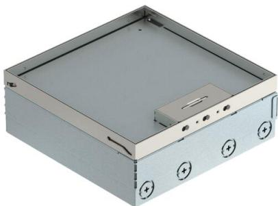
Toretta a scomparsa all-in-one quadrata per l'installazione in pavimenti flottanti e/o massetto trattati con lavaggio a secco. Alloggiamento da incasso con aperture preforate per tubi (M25) su tutti i lati. Con 3 supporti universali UT4 e due prese doppie. Elemento superiore regolabile sul bordo superiore del rivestimento grazie a 4 supporti di livellamento. La profondità di montaggio minima è 95 mm, il campo di livellamento + 30 mm.
