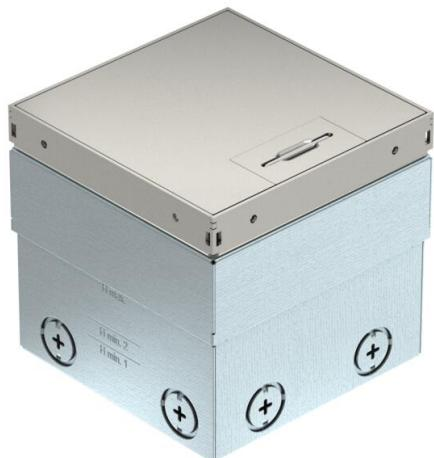
Pozzetto quadrato per l'installazione in pavimenti flottanti ed in massetto trattati con lavaggio a secco in ambienti interni. Alloggiamento da incasso con aperture preforate per tubi (M20/M25). Elemento superiore regolabile sul bordo superiore del rivestimento grazie a 4 supporti di livellamento. La profondità minima di installazione è di 100 mm, l'area di livellamento + 35 mm.
