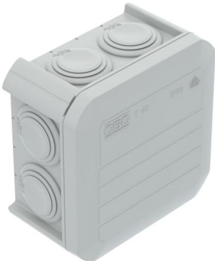
Boîtier de dérivation pour le raccordement des câbles et conduits en intérieur et dans des espaces extérieurs protégés. Forme carrée avec embouts à gradins sur les côtés et entrées défonçables dans le fond. Convient pour le montage au mur/au plafond et sur des tôles de montage. Avec possibilité de fixation intérieure. Avec couvercle à encliquer. Modèle résistant aux flammes en polypropylène spécial.
