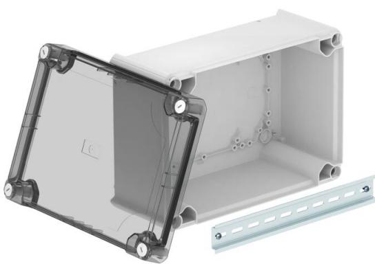
Scatola di derivazione chiusa per il collegamento di cavi e linee in ambienti interni e ambienti esterni protetti. Forma rettangolare senza ingressi. Adatta per il montaggio su pareti e soffitti, il montaggio su piastre di montaggio e filettatura nel pavimento. Con la possibilità di fissaggio interno e montaggio su sezioni angolari. Coperchio alto e trasparente con chiusura rapida, piombabile. Costruito con materiali privi di alogenri.
