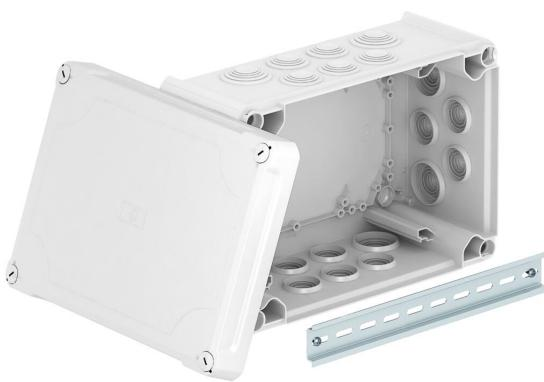
Kabelabzweigkasten zum Verbinden von Kabeln und Leitungen im Innenbereich und geschützten Außenbereichen. Rechteckige Form mit Einstechdichtungen. Geeignet für die Wand-/ Deckenmontage, die Montage auf Montageblechen und Gewinde im Boden. Mit der Möglichkeit zur Innenbefestigung und Montage über die Eckdome. Hoher Deckel mit Schnellverschluss, plombierbar. Hergestellt aus halogenfreien und UV-resistenten Materialien.
