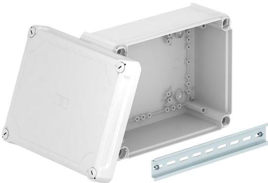
Kabelabzweigkasten geschlossen zum Verbinden von Kabeln und Leitungen im Innenbereich und geschützten Außenbereichen. Rechteckige Form ohne Einführungen. Geeignet für die Wand-/ Deckenmontage, die Montage auf Montageblechen und Gewinde im Boden. Mit der Möglichkeit zur Innenbefestigung und Montage über die Eckdome. Hoher Deckel mit Schnellverschluss, plombierbar. Hergestellt aus halogenfreien und UV-resistenten Materialien.
