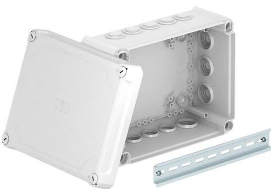
Kabelabzweigkasten zum Verbinden von Kabeln und Leitungen im Innenbereich und geschützten Außenbereichen. Rechteckige Form mit Einstechdichtungen an den Seiten und Ausschlägeöffnungen im Boden. Geeignet für die Wand-/ Deckenmontage, die Montage auf Montageblechen und Gewinde im Boden. Mit der Möglichkeit zur Innenbefestigung und Montage über die Eckdome. Hoher Deckel mit Schnellverschluss, plombierbar. Hergestellt aus halogenfreien und UV-resistenten Materialien.
