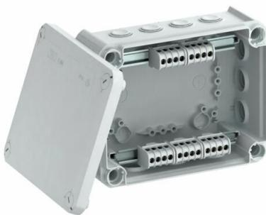
Scatola di derivazione con morsettiera per il collegamento di cavi e linee in ambienti interni e ambienti esterni protetti. Forma rettangolare con tenute a innesto sui lati e inserti di deviazione nel fondo. Adatta per il montaggio su pareti e soffitti e il montaggio su piastre di montaggio. Con la possibilità di fissaggio interno e montaggio tramite cupole angolari. Coperchio con chiusura rapida, piombabile. Realizzato con materiali privi di alogenri e resistenti ai raggi UV.
