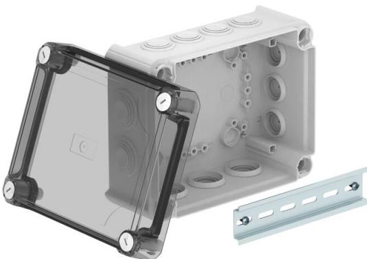
Kabelabzweigkasten zum Verbinden von Kabeln und Leitungen im Innenbereich und geschützten Außenbereichen. Rechteckige Form mit Einstechdichtungen an den Seiten und Ausschlägeöffnungen im Boden. Geeignet für die Wand-/ Deckenmontage und die Montage auf Montageblechen. Mit der Möglichkeit zur Innenbefestigung und Montage über die Eckdome. Hoher, transparenter Deckel mit Schnellverschluss, plombierbar. Hergestellt aus halogenfreien und UV-resistenten Materialien.
