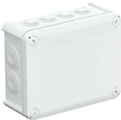
Scatola di derivazione per il collegamento di cavi e linee in ambienti interni e ambienti esterni protetti. Forma rettangolare con tenute a innesto sui lati e inserti di deviazione nel fondo. Adatta per il montaggio su pareti e soffitti e il montaggio su piastre di montaggio. Con la possibilità di fissaggio interno e montaggio su sezioni angolari. Coperchio con chiusura rapida, piombabile. Versione resistente alla fiamma in polipropilene speciale.
