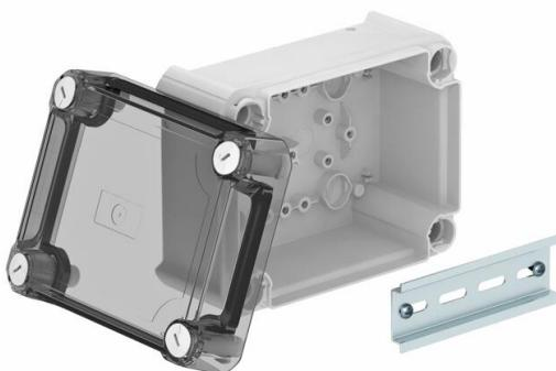
Kabelabzweigkasten geschlossen zum Verbinden von Kabeln und Leitungen im Innenbereich und geschützten Außenbereichen. Rechteckige Form ohne Einführungen. Geeignet für die Wand-/ Deckenmontage und die Montage auf Montageblechen. Mit der Möglichkeit zur Innenbefestigung und Montage über die Eckdomäne. Hoher, transparenter Deckel mit Schnellverschluss, plombierbar. Hergestellt aus halogenfreien und UV-resistenten Materialien.
