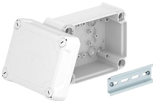
Kabelabzweigkasten geschlossen zum Verbinden von Kabeln und Leitungen im Innenbereich und geschützten Außenbereichen. Rechteckige Form ohne Einführungen. Geeignet für die Wand-/ Deckenmontage und die Montage auf Montageblechen. Mit der Möglichkeit zur Innenbefestigung und Montage über die Eckdomäne. Hoher Deckel mit Schnellverschluss, plombierbar. Hergestellt aus halogenfreien und UV-resistenten Materialien.
