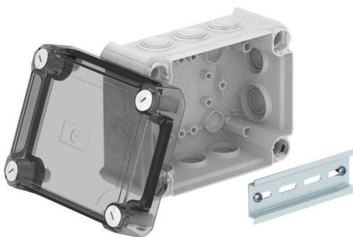
Kabelabzweigkasten zum Verbinden von Kabeln und Leitungen im Innenbereich und geschützten Außenbereichen. Rechteckige Form mit Einstechdichtungen an den Seiten und Ausschlägeöffnungen im Boden. Geeignet für die Wand-/ Deckenmontage und die Montage auf Montageblechen. Mit der Möglichkeit zur Innenbefestigung und Montage über die Eckdome. Hoher, transparenter Deckel mit Schnellverschluss, plombierbar. Hergestellt aus halogenfreien und UV-resistenten Materialien.
