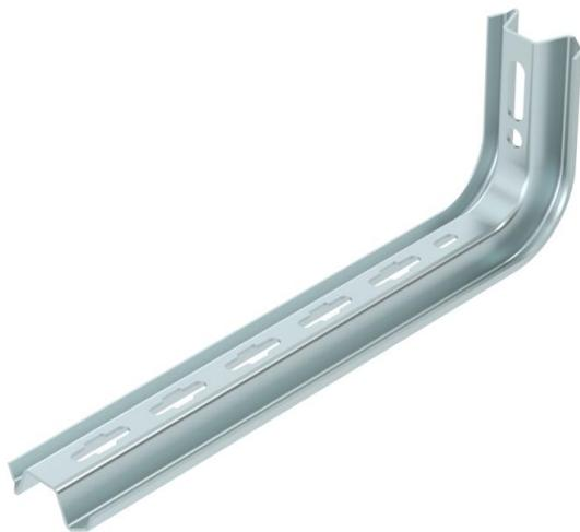
Profilo TP come sospensione leggera per il fissaggio a soffitti in calcestruzzo orizzontali, lunghezze da 145 - 645 mm. Fino a la lunghezza 345 mm il profilo puo essere utilizzato anche come mensola a parete.
