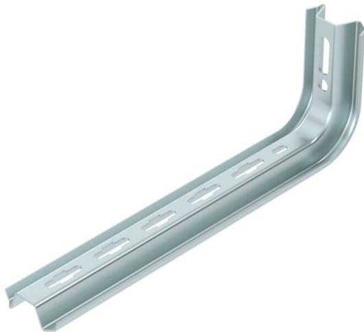
Profilé TP à utiliser comme pendarde léger sur les plafonds en béton horizontaux, longueur 145 à 645 mm. Jusqu'à la longueur de 345 mm, le profilé est également utilisé comme console murale ou de pendarde légère.
