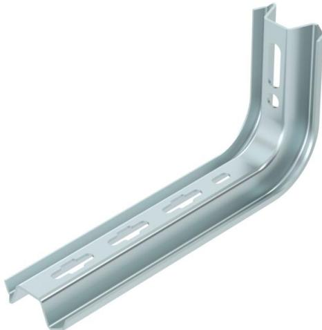
Profilo TP come sospensione leggera per il fissaggio a soffitti in calcestruzzo orizzontali, lunghezze da 145 - 645 mm. Fino a la lunghezza 345 mm il profilo puo essere utilizzato anche come mensola a parete.
