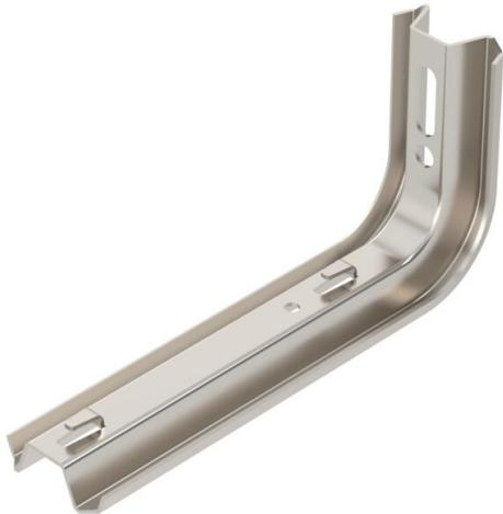
Mensola TP con morsetti per il fissaggio senza viti della passerella grigliata. Se la mensola viene fissata direttamente alla parete o i profilati vengono avvitati fra loro per motivi di stabilità, è sempre necessario utilizzare il distanziatore tipo DS 4.
