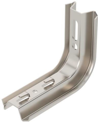
TP-Ausleger mit Klemmlaschen zur schraubenlosen Gitterinnenbefestigung. Wird der Ausleger direkt an der Wand befestigt oder werden die Profile gegeneinander geschraubt, so ist aus Stabilitätsgründen immer das Distanzstück Typ DS 4 einzusetzen. Auf dem TP-Ausleger können Gitterrinnen mit der Maschenweite 50 x 100 mm z. B. Typ GRL, GR und GRM schraubenlos befestigt werden.
