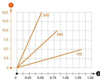
Belastungsdiagramm Deckenbügel TPDG
