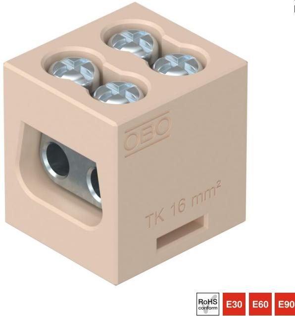
Hochtemperaturbeständige Keramikklemme mit 4 Anschlussmöglichkeiten zum Nachrüsten der FireBox T-Serie. Geprüft nach DIN EN 60998-2-1:2004.
