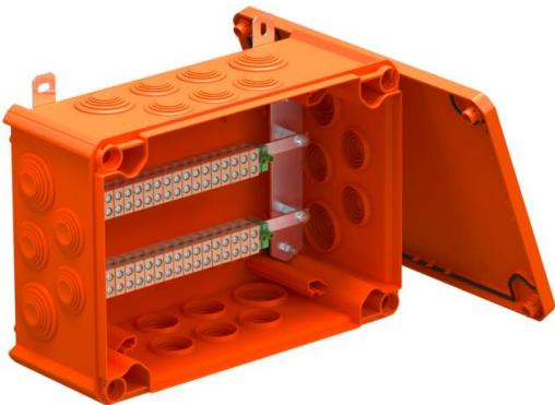
Verbindungskasten für Datentechnik mit weichen Einstechdichtungen. Paarige Anzahl der hochtemperaturbeständigen Keramikklemmen passend zu Datenleitungen. Grün-gelb gekennzeichnete Schutzleiter-/Schirmklemme. Befestigung an gut zugänglichen Außenlaschen. Zugelassen für Kabelanlagen mit elektrischem Funktionserhalt nach DIN 4102 Teil 12 mit den Klassen E30, E60 und E90. Keramikklemmen wurden nach DIN EN 60998-2-1:2004 geprüft.
