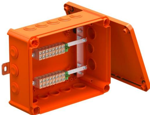
Verbindungskasten für Datentechnik mit weichen Einstechdichtungen. Paarige Anzahl der hochtemperaturbeständigen Keramikklemmen passend zu Datenleitungen. Grün-gelb gekennzeichnete Schutzleiter-/Schirmklemme. Befestigung an gut zugänglichen Außenlaschen. Zugelassen für Kabelanlagen mit elektrischem Funktionserhalt nach DIN 4102 Teil 12 mit den Klassen E30, E60 und E90. Keramikklemmen wurden nach DIN EN 60998-2-1:2004 geprüft.
