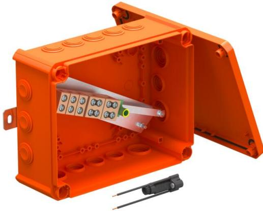
Kabelabzweigkasten mit einem Sicherungshalter und weichen Einsteckdichtungen. Ausreichender Verdrahtungsraum durch diagonal angeordnete Anschluss-einheit mit komplett vormontierten hochtemperaturbeständigen Keramikklem-men. Grün-gelb gekennzeichnete Schutzleiterklemme. Befestigung an gut zu-gänglichen Außenlaschen. Zugelassen für Kabelanlagen mit elektrischem Funkti-onserhalt nach DIN 4102 Teil 12 mit den Klassen E30, E60 und E90. Keramik-klemmen wurden nach DIN EN 60998-2-1:2004 geprüft.
