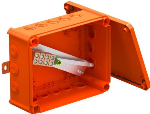
Verbindungskasten mit weichen Einstechdichtungen. Ausreichender Verdrahtungsraum durch diagonal angeordnete Anschlusseinheit mit komplett vormontierten hochtemperaturbeständigen Keramikklemmen. Grün-gelb gekennzeichnete Schutzleiterklemme. Befestigung an gut zugänglichen Außenlaschen. Zugelassen für Kabelanlagen mit elektrischem Funktionserhalt nach DIN 4102 Teil 12 mit den Klassen E30, E60 und E90. Keramikklemmen wurden nach DIN EN 60998-2-1:2004 geprüft.
