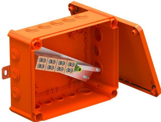
Kabelabzweigkasten mit keramischen Doppelklemmen und weichen Einstechdichtungen. Ausreichender Verdrahtungsraum durch diagonal angeordnete Anschlusseinheit mit komplett vormontierten hochtemperaturbeständigen Keramikklemmen. Grün-gelb gekennzeichnete Schutzleiterklemme. Befestigung an gut zugänglichen Außenlaschen. Zugelassen für Kabelanlagen mit elektrischem Funktionserhalt nach DIN 4102 Teil 12 mit den Klassen E30, E60 und E90. Keramikklemmen wurden nach DIN EN 60998-2-1:2004 geprüft.
